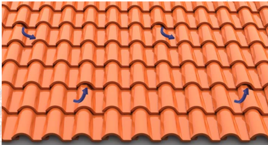
Figura 35. Disposición desencontrada de tejas de entrada y salida de aire
