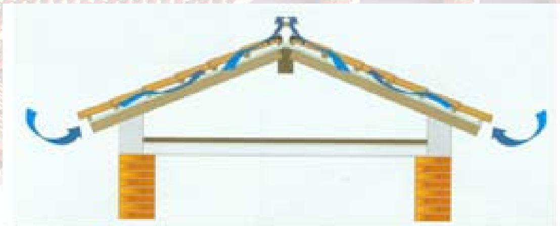
Figura 31. Recorrido ideal del estrato de microventilación
