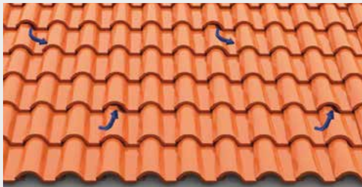
Disposición desencontrada de tejas de ventilación de entrada y salida de aire
