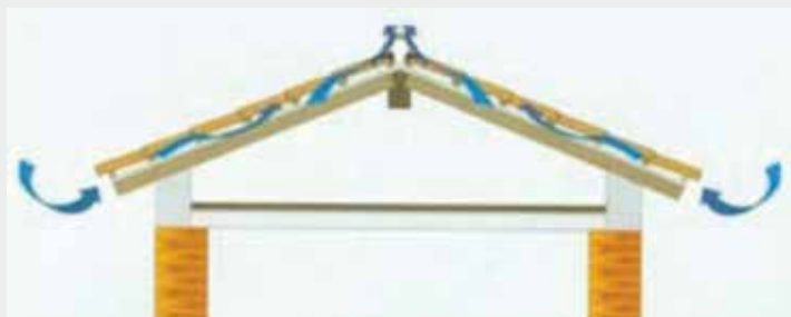
Recorrido ideal del aire en la microventilación
